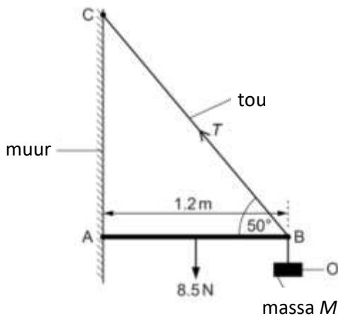
Die hoek tussen die staaf en die tou by B is  $50^\circ$ . Die staaf het 'n lengte van 1.2 m en gewig van 8.5 N. 'n Voorwerp O met massa M word aan die staaf gehang by B. Die spanning T in die tou is 30 N.
