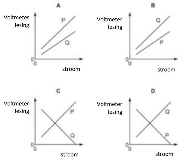
56. Twee drade P en Q, wat van dieselfde materiaal gemaak is, is aan dieselfde elektriese spanningsbron verbind. P is twee keer so lank soos Q en P se deursnee is een derde van die deursnee van Q, soos in die diagram gewys.
