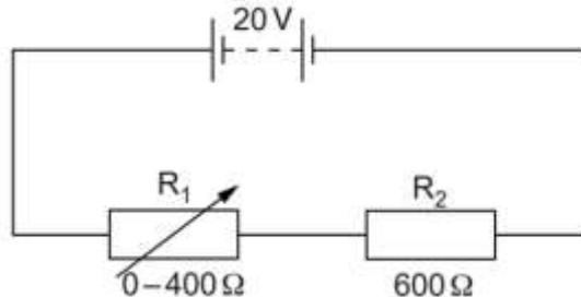
Die weerstand van  $R_2$  is  $600 \Omega$ . Die weerstand van  $R_1$  word verstel van 0 tot  $400 \Omega$ .
