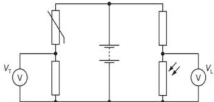
Die lesings  $V_T$  en  $V_L$  is albei hoog. Wat is die korrekte beskrywing van die temperatuur en die lichtintensiteit?
