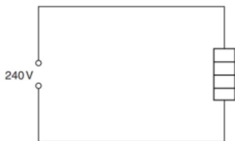
Die draad wat gebruik word om die verwarming aan die kragbron te verbind het elk 'n lengte van 75 m. Die draad het 'n deursnee area van  $2.5 \text{ mm}^2$  en resistiwiteit van  $18 \text{ n}\Omega \text{ m}$ . Die verwarming het 'n konstante weerstand van  $38 \Omega$ .
